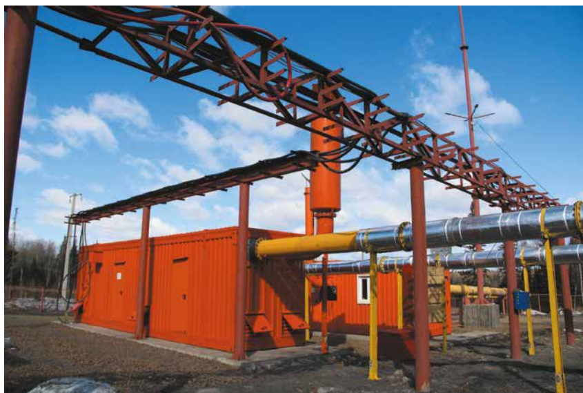
Для ведения горных работ в зоне с метаноносностью более 9 м 3 /т в условиях шахты «Южная» (филиал АО «Черниговец») к вводу в эксплуатацию готовится установка МДУ-240 RBS отечественного производства. Она предназначена для обеспечения безопасных условий труда шахтеров
