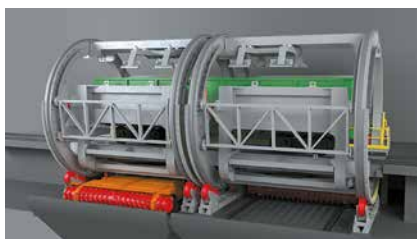
Трехмерная модель комплекса из вагонопрокидывателя, надбункерных решеток и пары дробильно-фрезерных машин производства ООО «СОЭЗ»
