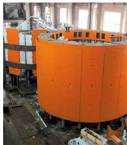
Общий вид двух комбайнов типа СПКВ в сборочном цехе ООО «Скуратовский опытно-экспериментальный завод»
