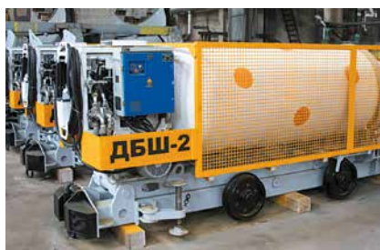
Доставщики бетона шахтные в сборочном цехе ООО «СОЭЗ», г. Тула
