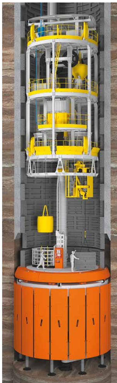
Стволопроходческий комбайн (оранжевый) и проходческий полк (желтый)
